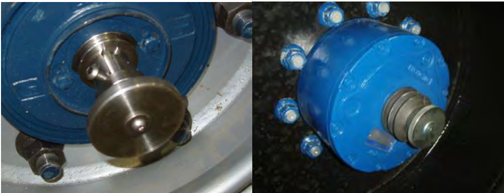
WIELAANDRIJVING ONTKOPPELD, UITGETROKKEN
